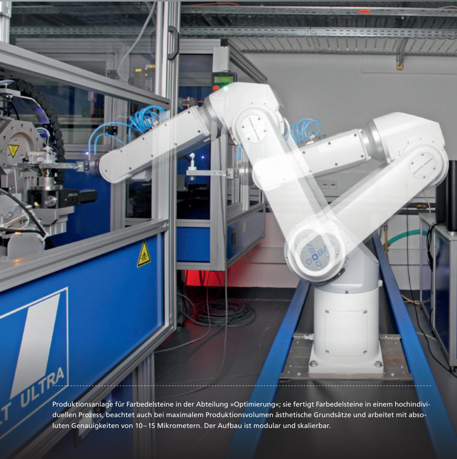
Produktionsanlage für Farbedelsteine in der Abteilung »Optimierung«; sie fertigt Farbedelsteine in einem hochindividuellen Prozess, beachtet auch bei maximalem Produktionsvolumen ästhetische Grundsätze und arbeitet mit absoluten Genauigkeiten von 10–15 Mikrometern. Der Aufbau ist modular und skalierbar.
