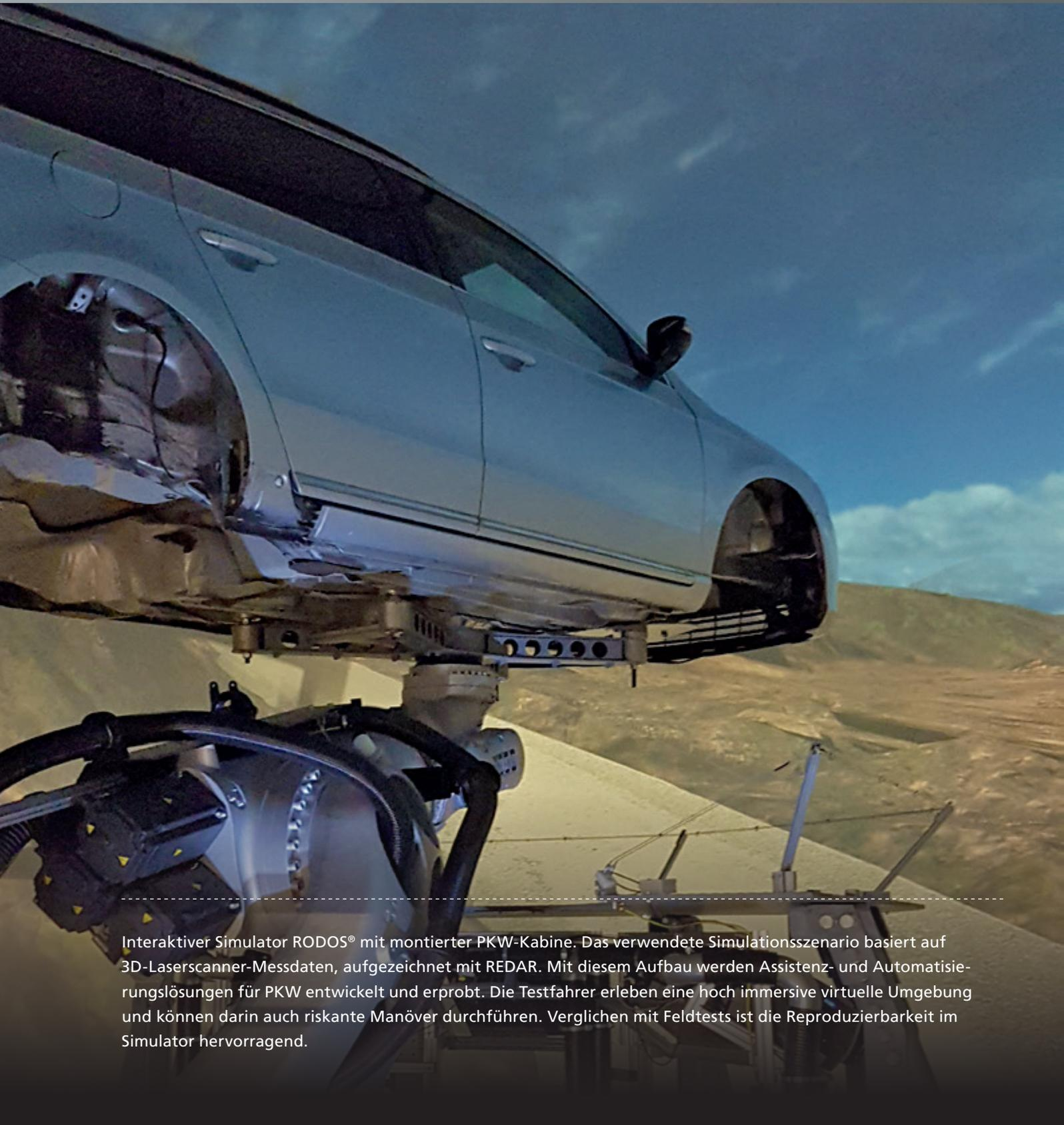
Interaktiver Simulator RODOS® mit montierter PKW-Kabine. Das verwendete Simulationsszenario basiert auf 3D-Laserscanner-Messdaten, aufgezeichnet mit REDAR. Mit diesem Aufbau werden Assistenz- und Automatisierungslösungen für PKW entwickelt und erprobt. Die Testfahrer erleben eine hoch immersive virtuelle Umgebung und können darin auch riskante Manöver durchführen. Verglichen mit Feldtests ist die Reproduzierbarkeit im Simulator hervorragend.
